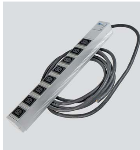
Kaltgeräte-Steckdosenleiste, 8fach, IEC320, mit 10A Feinsicherung ohne Schalter
